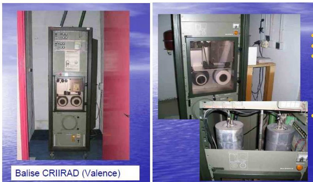
Vue d'une balise / vue des blindages en plomb des détecteurs
